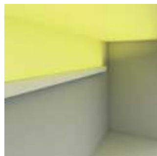
5. Applique mono-émission lèche-plafond (moitié de la puissance).
